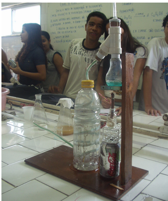
Figura 17 – Destilador produzido pela turma da 1ª série do ensino médio do CIEP 476 com material alternativo e de baixo custo.
